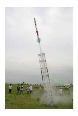
CEES (Cryogenic, Economical, Ecological, and Safe) ロケットは、推進剤に液体窒素を、加熱剤に温水を使用する非燃焼型ロケットである。このロケットは燃焼過程を伴わないため、経済的で、環境にも優しく、安全に取り扱うことができるので、学生の教育用ロケットとして、優れた点を多く持つと考えられる。大阪府立大学では、CEES ロケットの利点を生かした、Can-Sat 打ち上げ用 CEES ロケットの開発を進めている。2006 年 9 月に、CEES-2A 号機の打ち上げ試験を行った。昨年度打上げに成功した CEES-1 号機からの大きな変更点は、タンク押し出し方式、燃料タンク構造、フェアリング開放方式の三つである。結果は、目標高度(150 m)には届かず、完全な状態での回収はできなかった。その主原因として噴射時間が短く、質量流量の制御に問題があることがわかった。そこで、我々は極低温流体であるため、これまで困難であった液体窒素の質量流量の計測に取組み、その計測に成功した。
