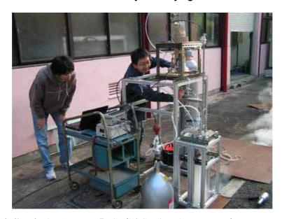
近年、多くの大学で小型ロケットの開発が活発に行われている。我々は、 LN2 と H2O による安全性を最大限に考慮した、非燃焼型ロケットエンジンシステムに着目し、エンジン部の小型化、軽量化、高性能化と信頼性の向上を研究している。今年度、混合室と LN2 タンクを一体化させた、バルブレス構造を有する非燃焼型エンジンを開発し、地上噴射実験を行った。その結果、最大推力 130N (混合室圧力 0.45MPa、スロート面積 240.8mm2)を得た。また、LN2 と H2O の混合促進を図るため、混合室への H2O の噴射口に H2O の比表面積増大を目的としたシャワーキャップ(開口率 0.4)を取り付け、噴射実験を行った。その結果、混合初期における素早い推力の立ち上がりと、最大推力 225N (混合室圧力 0.8MPa、スロート面積 240.4mm2)の持続が確認できた。なお、これらの実験結果は、1 次元ノズル解析から得られる混合室圧力と推力の関係において、理論値とほぼ一致した。
