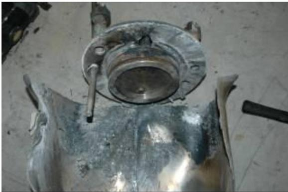
図 7 異常燃焼後の噴射器周辺の外観
