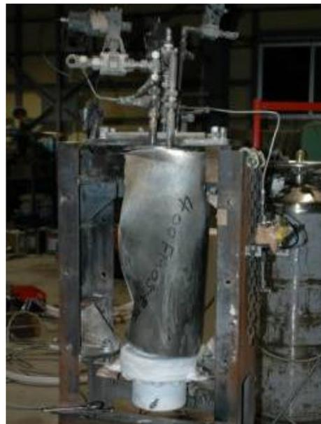
図 8 異常燃焼後のモータの外観
