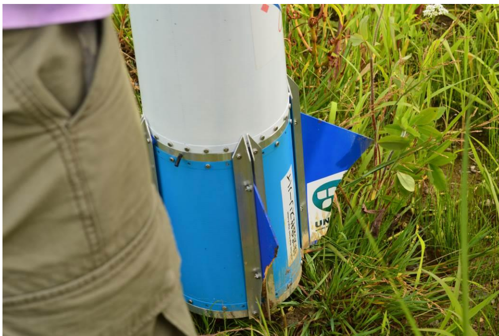
図 3.3.5 フィンの破損
