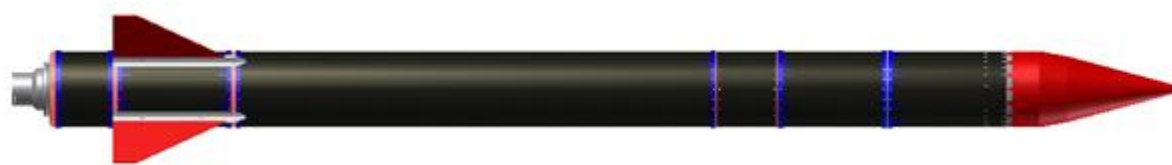
図 3.2.3 強化リングとカプラの固定位置
