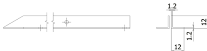
図 3.2.6 フィンの固定アルミ L 字アンゲル寸法
