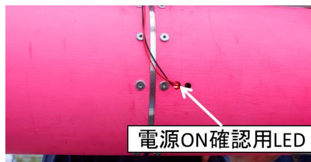
図 3.4.3 分離回路の電源 ON 確認用 LED 点灯の確認（打上前 25 分前）
