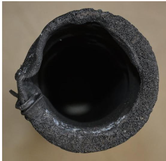
図 3.1.3 脱落したノズル部
