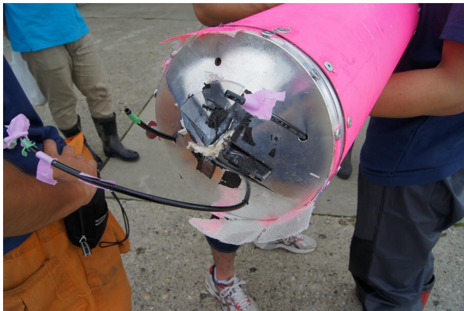
図 3.2.7 エンジン上部のアルミ材カプラーの破損状況
