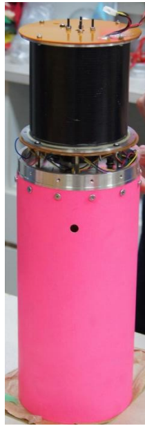
図 3.4.1 分離回路搭載の様子（1 段目分離機構の下部モジュール） * 黒いモジュールが分離回路用水密ケースである。
