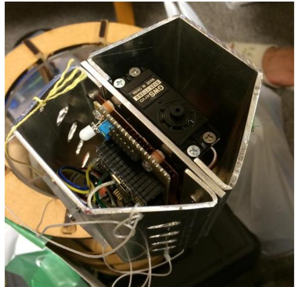
本年度機体は、アルミを主な材料として製作された。形状はほぼ六角柱であり、機体設計の目標としては、電装部分を確実に保護する事、キャリアに余裕をもって収まる事、風によって影響を受けにくい形状である事を掲げている。またパラfoilについては、Hobbyking 製パラfoilの糸を釣り糸を用いて本年度機体に合わせて張り替えたものを使用した。
