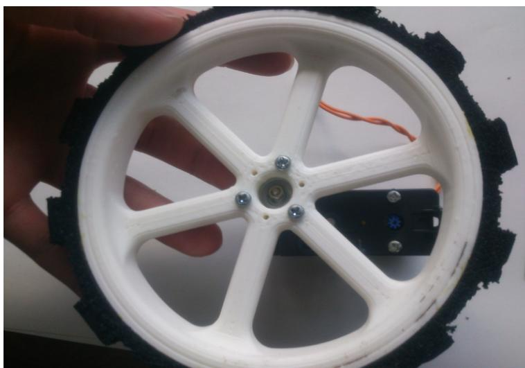
Fig.3 3Dプリンタで製作したホイール
