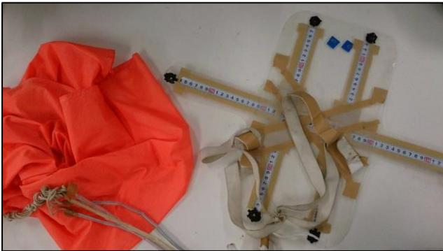
パラシュート(50inch)分離のためのパラシュート分離機構(構体カバー)を持ち、テグスをニクロム線の熱で焼ききることによって分離を行う。また構体カバーはスポンジ(ウレタンフォーム #6)タイヤを規定サイズ内まで収縮する働きも持つ。
