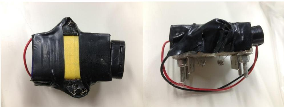
図6 水銀スイッチによる分離機構
