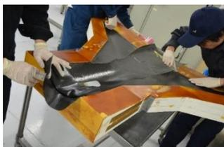
CFRPの機体製作
