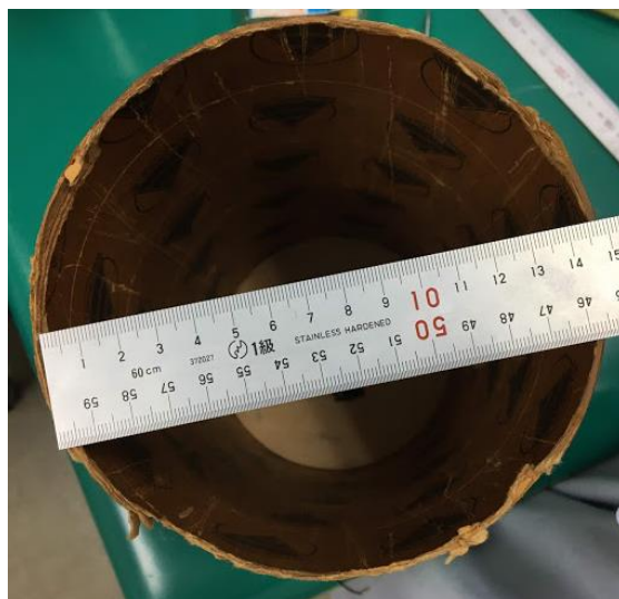
図 6.2.2 キャリア収納ケースの外形寸法
