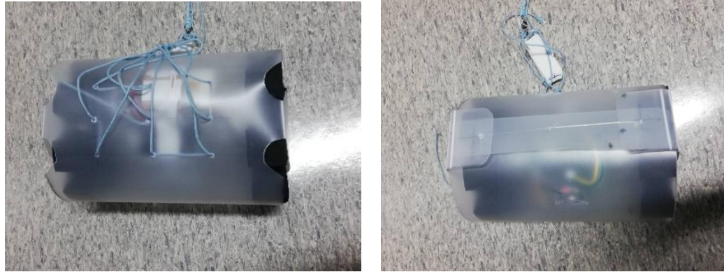
図 4.1.4 分離機構に包んだ様子 (左：パラシュートとの接続部 右：ナイロンによる固定の様子)
