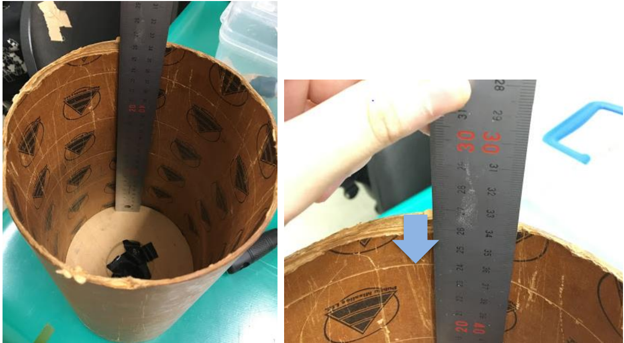
図 6.2.1 キャリア収納ケースの奥行寸法
