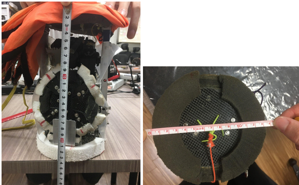
Fig. 6.2.2 CanSatの高さと直径（240mm, 135mm）
