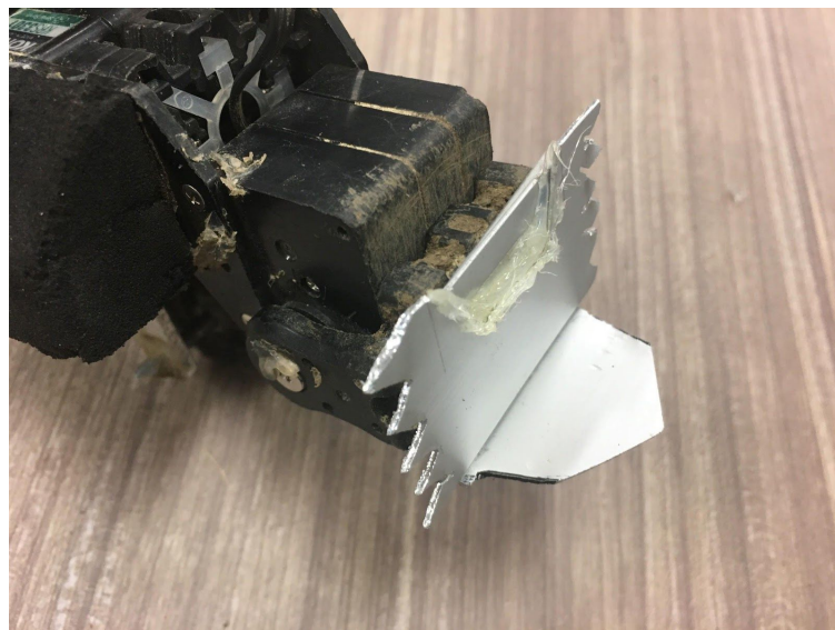
Fig. 4.3.3 サーボモータを左右に曲げた様子
