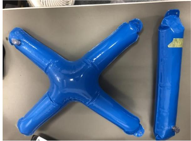
Figure 3 バルーン (インフレーターブル構造)
