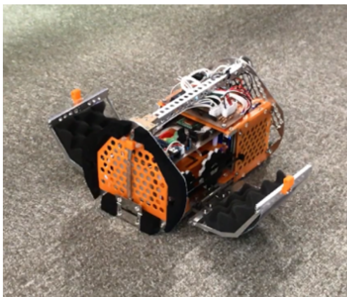
図 5.1-1 ケース前面蓋の開口前の様子
