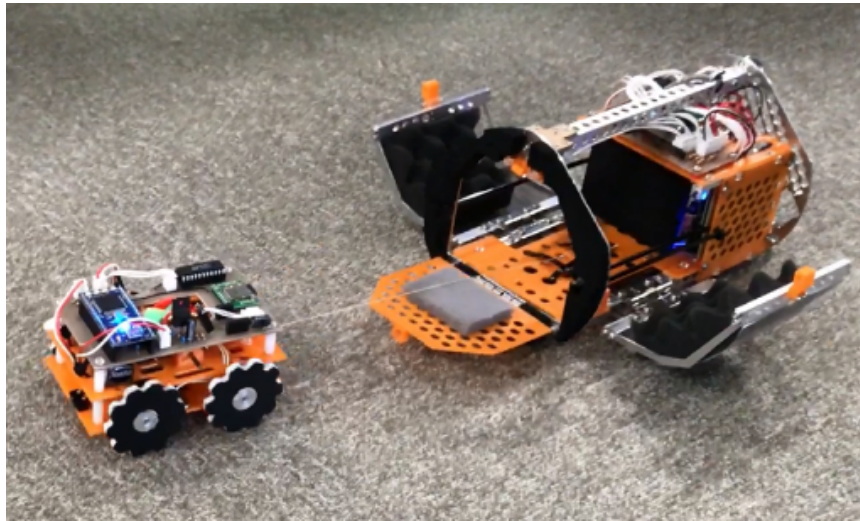
図 5.1-3 ケース部とローバー部分が分離した様子
