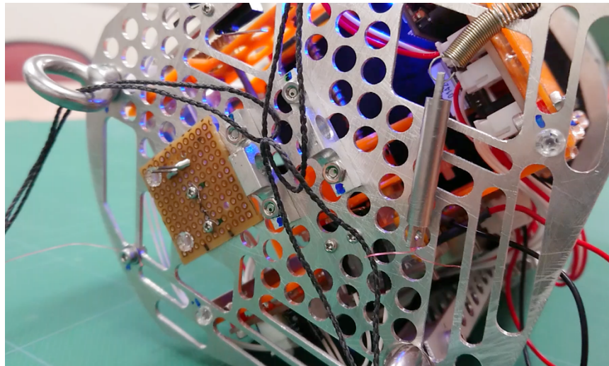
図 5.2-1 パラシュート分離機構溶断
