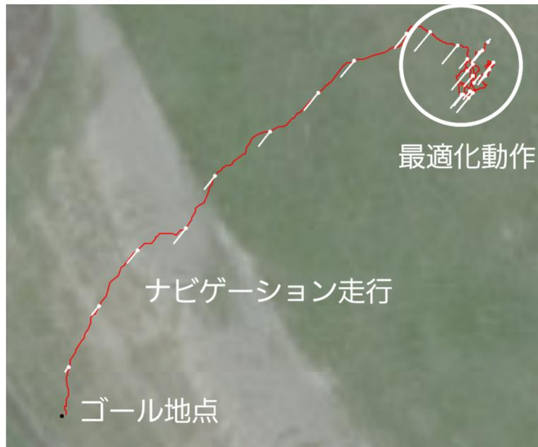
図6.38 GPSセンサ軌跡の動作詳細
