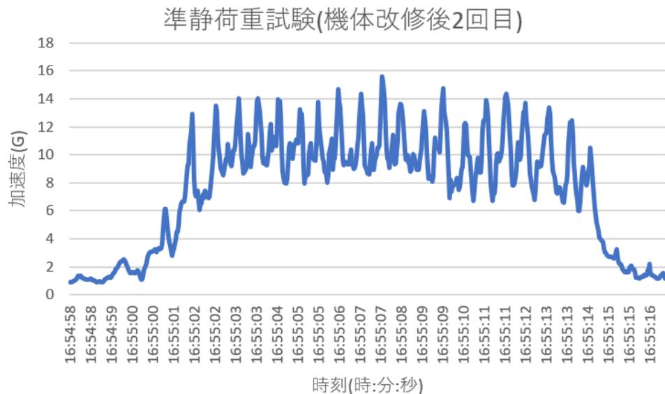
図6.25 準静荷重試験 機体改修後2回目の加速度グラフ
