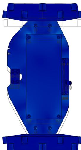
図6.32 Von-Mises応力
