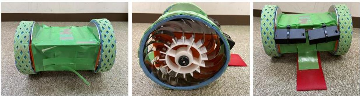
図 4.1.6 実験用 CanSat 模擬機体(左: 前面, 中: 側面, 右: 背面)
