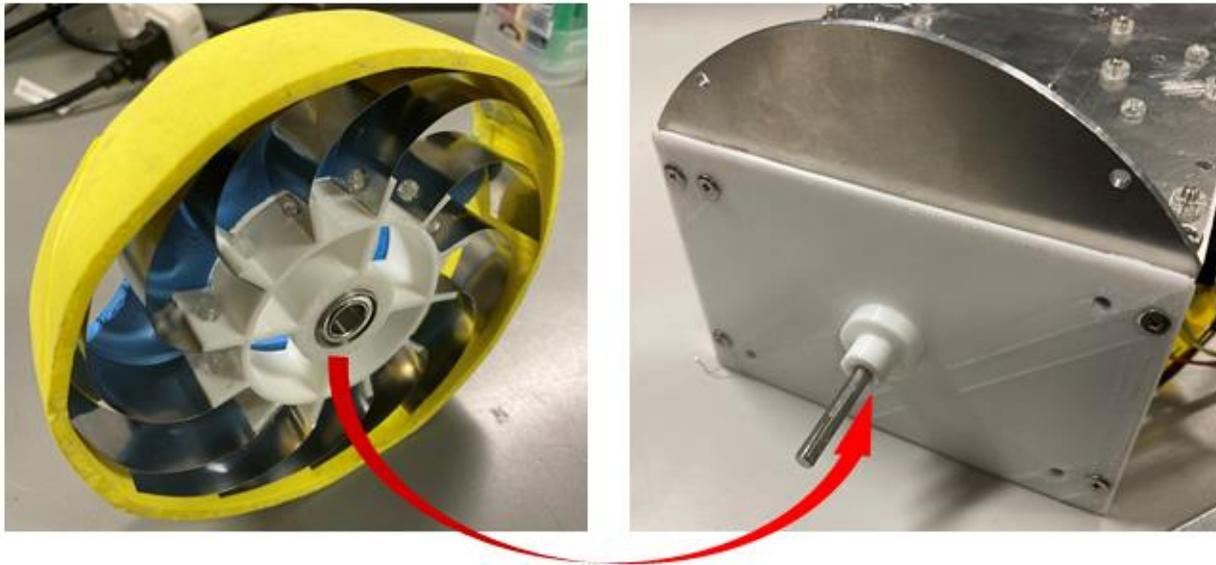
図 4.2.9 車輪-筐体接続部（左：車輪側、右：筐体側）
