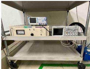
図 6.6.2 加振機コントローラ
