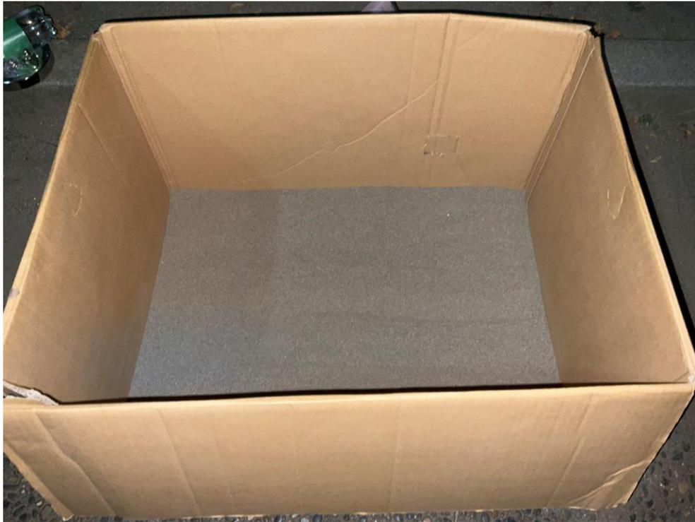
図 4.1.7 砂地を模擬した砂入り段ボール
