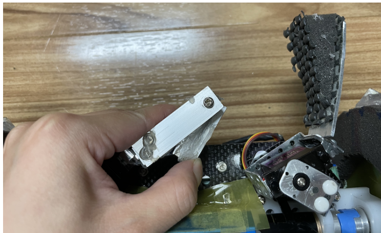
図4.21 運搬機構(折り畳んでいる様子) ※機体を裏返して撮影
