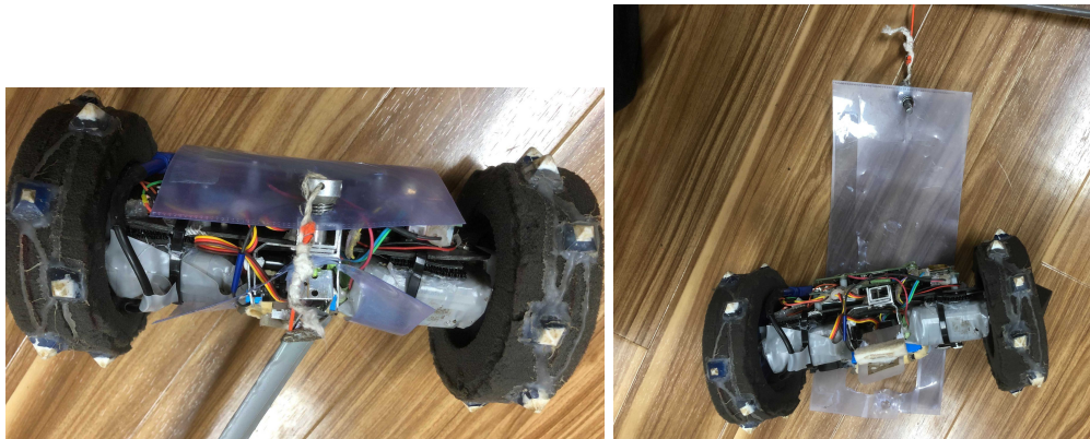
図4.24 プロテクター固定時(左)と展開時(右)
