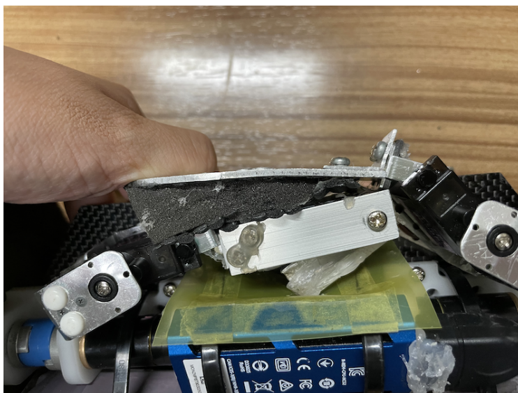
図4.22 運搬機構(キャリア内の収納状態) ※機体を裏返して撮影
