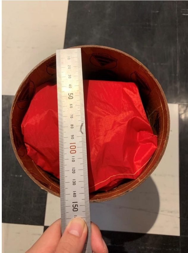
図 6.2 キャリア格納試験(直径)
