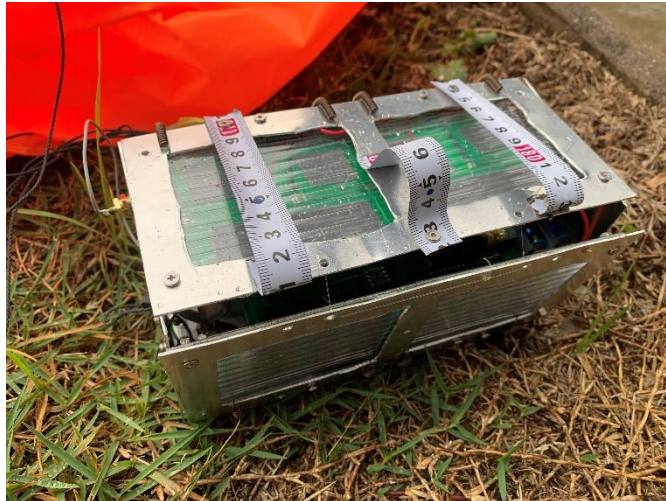
図 6.7 投下試験後の CanSat
